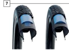
Die sichersten Schutzgürtel für Fahrradreifen und E-Bike Reifen. Hochelastischer Spezialkautschuk als 5 mm starke Einzellage (SmartGuard) oder 4 mm in Kombination mit 2 Lagen Nylongewebe (Smart DualGuard).
