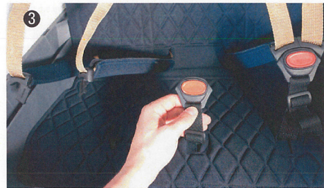
Verschieben Sie nach Bedarf das Gurtschloss in die mittlere Position der Sitzbank (Mittig positionierte Hängematte).
