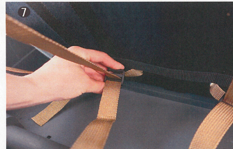
Die entsprechenden Sitzgurte im Kofferraum des Hängers aus den Schnallen anschließen.
