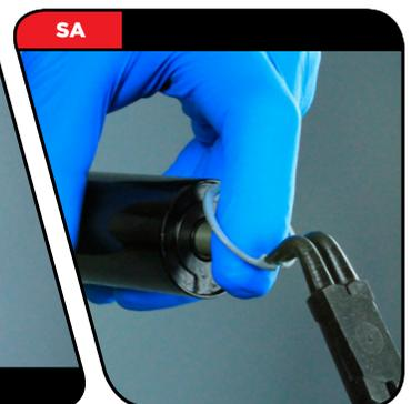
**6** Schrauben Sie die untere Schraube in die Luftführungsstange, um die Luftführungsstange aus dem Standrohr zu ziehen.
