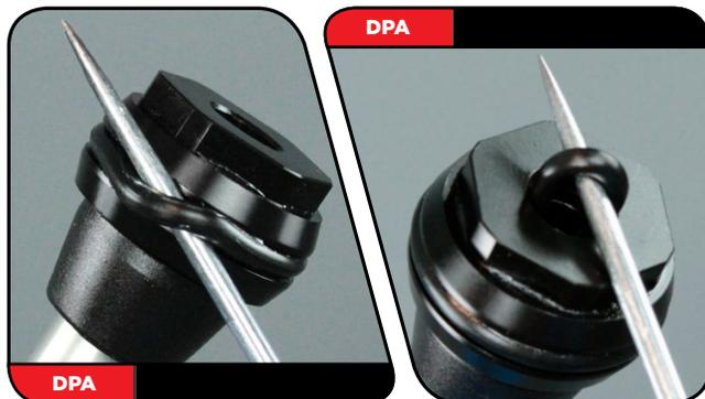
**Nur Solo Air:** Entfernen Sie mit einem Dorn oder mit den Fingern den Quadring des Luftkolbens.
