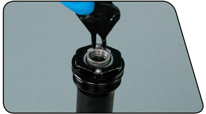
**16** Öffnen Sie die Zugstufen-Baugruppe, indem Sie die Zugstufen-Führungsstange nach unten auseinanderziehen. Führen Sie dann einen 2,5-mm-Inbusschlüssel von unten in die Zugstufen-Führungsstange und drehen Sie sie bis zum Anschlag gegen den Uhrzeigersinn.
