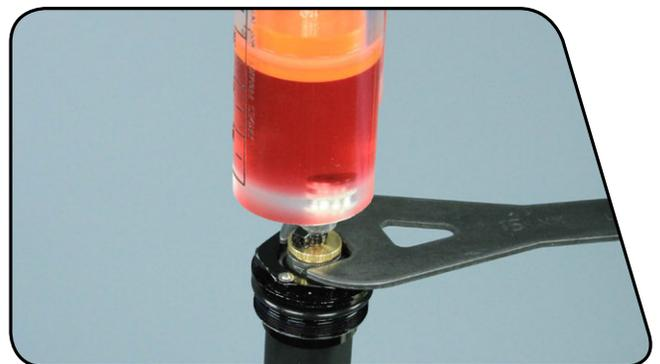
**18** Halten Sie die Zugstufen-Führungsstange in Position und Ziehen Sie den Kolben der Spritze auf, um einen Unterdruck in der Membran zu erzeugen.
