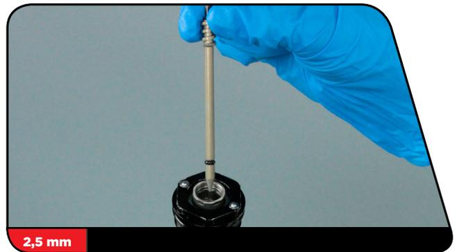
**14** Nur RCT3: Erfassen Sie mit einer Spitzzange die Abflachungen an der Druckstufennocken-Baugruppe. Ziehen Sie die Druckstufennocken-Baugruppe aus der Membran-Baugruppe heraus.
