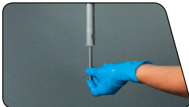
**19** Stellen Sie sicher, dass die Zugstufen-Führungsstange vollständig ausgezogen ist.
