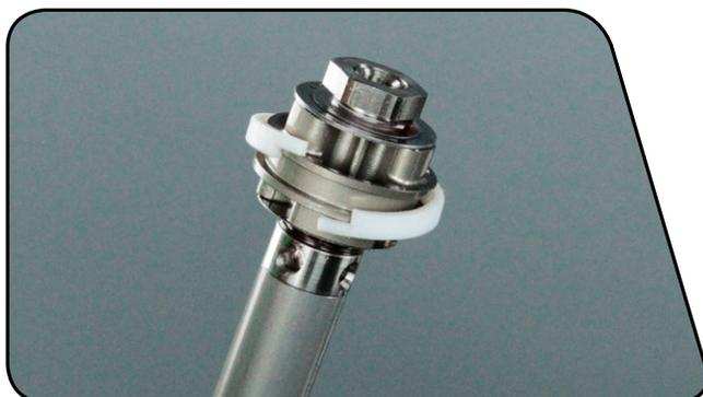
**9** Klemmen Sie die Abflachungen des Charger Damper™-Kupplungsstücks in einen Schraubstock ein. Platzieren Sie einen 21-mm-Maulschlüssel auf den Abflachungen des Patronenrohrs. Halten Sie die Membran-Baugruppe fest und drehen Sie den Maulschlüssel gegen den Uhrzeigersinn, um das Patronenrohr vom Kupplungsstück zu lösen und zu entfernen. Lassen Sie das Federungsöl in eine Ölauffangwanne ab.
