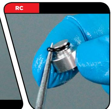
**12** Nur RCT3: Entfernen Sie mit einer kleinen Sprengzange den Sicherungsring von der Druckstufennocken-Baugruppe.
