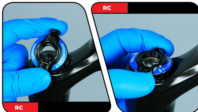
**27** **Nur RCT3:** Schrauben Sie die Befestigungsschraube des Einstellers in die Druckstufennocken-Baugruppe ein.
