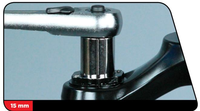
**26** **Nur RCT3:** Setzen Sie Druckstufenmodus-Einsteller mit der langen Lasche nahe an der Gabelvorderseite auf die Charger Damper™-Baugruppe auf. Drehen Sie den Druckstufenmodus-Einsteller **im Uhrzeigersinn**, bis er in die erste Rastvertiefung einrastet.
