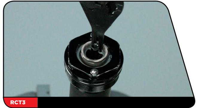
**Nur RC:** Entfernen Sie mit einer kleinen Sprengzange den Sicherungsring vom Entlüftungsstopfen.
