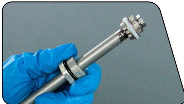
**7** Entfernen Sie mit einem Dorn oder mit den Fingern den O-Ring des Dichtkopfes. Stechen Sie mit einem Dorn in den Abstreifer und entfernen Sie ihn.
