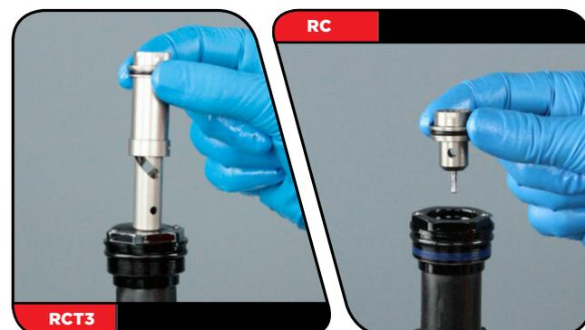
**15** **Nur RCT3:** Montieren Sie mit einer Sprengringzange den äußeren Sicherungsring, um die Druckstufennocken-Baugruppe zu fixieren. Wischen Sie überschüssiges Öl mit einem Lappen ab.
