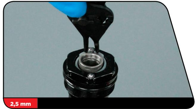
**13** Entfernen Sie mit einem 2,5-mm-Inbusschlüssel die Druckstufennadel.
