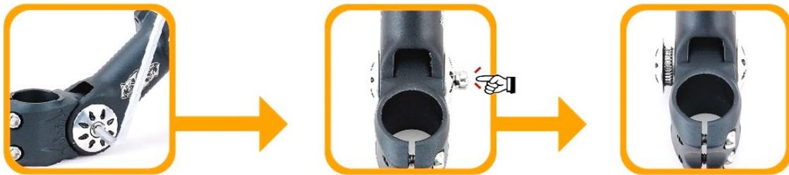
1. Öffnen Sie mit einem Innensechskantschlüssel die seitliche Schraube gegen den Uhrzeigersinn um ungefähr 5 Umdrehungen.
